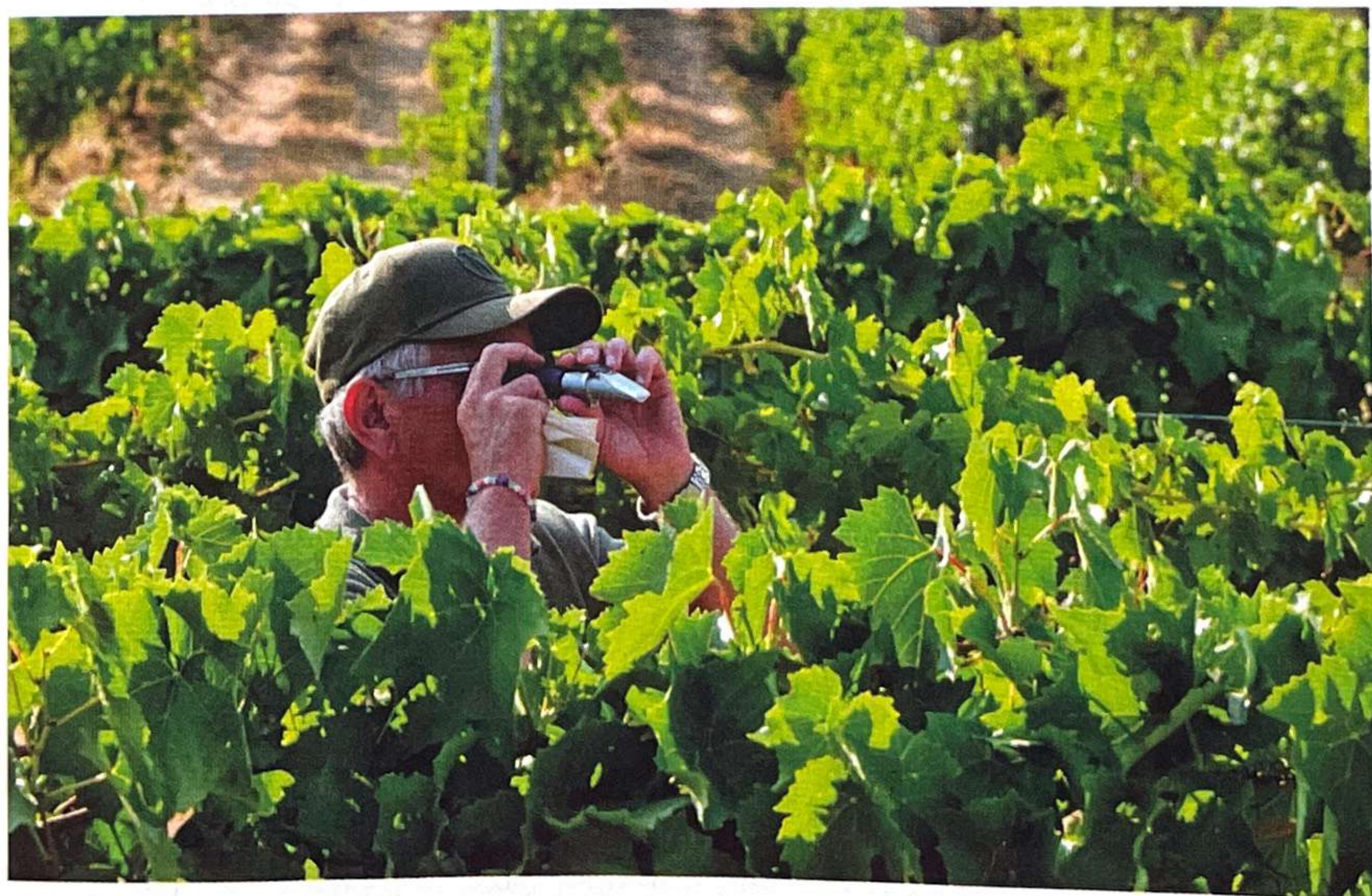
Jean-Charles Abbattucci utilise un réfractomètre pour mesurer le taux de sucre des raisins.
